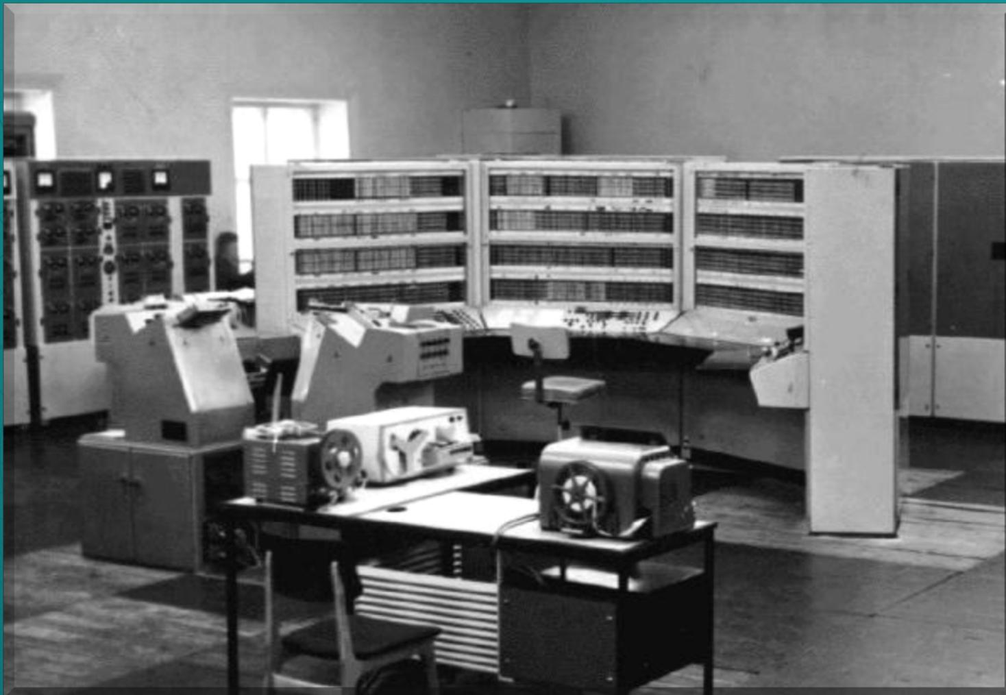
**В электронных схемах БЭСМ6 использовано 60 тыс. транзисторов и 180 тыс. полупроводников диодов. Элементная база БЭСМ6 по тем временам была совершенно новой, в ней были заложены основы схемотехники ЭВМ третьего и четвертого поколений.**
